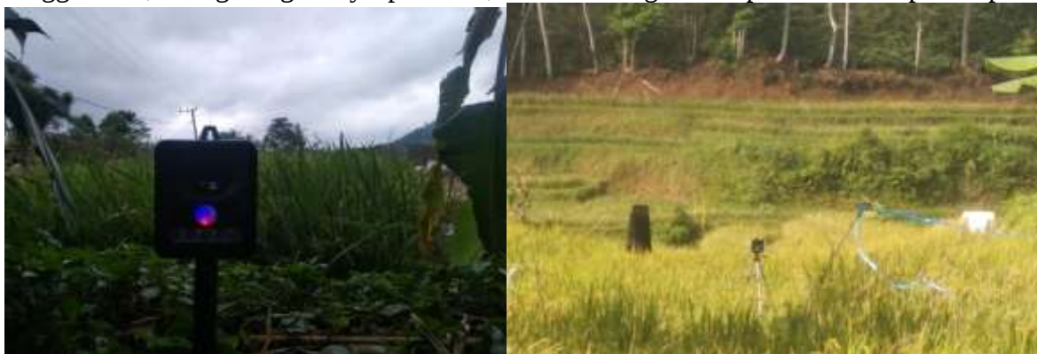
Gambar 2. (a) Piranti Gelombang Ultrasonik, (b) Aplikasi Piranti di Sawah
