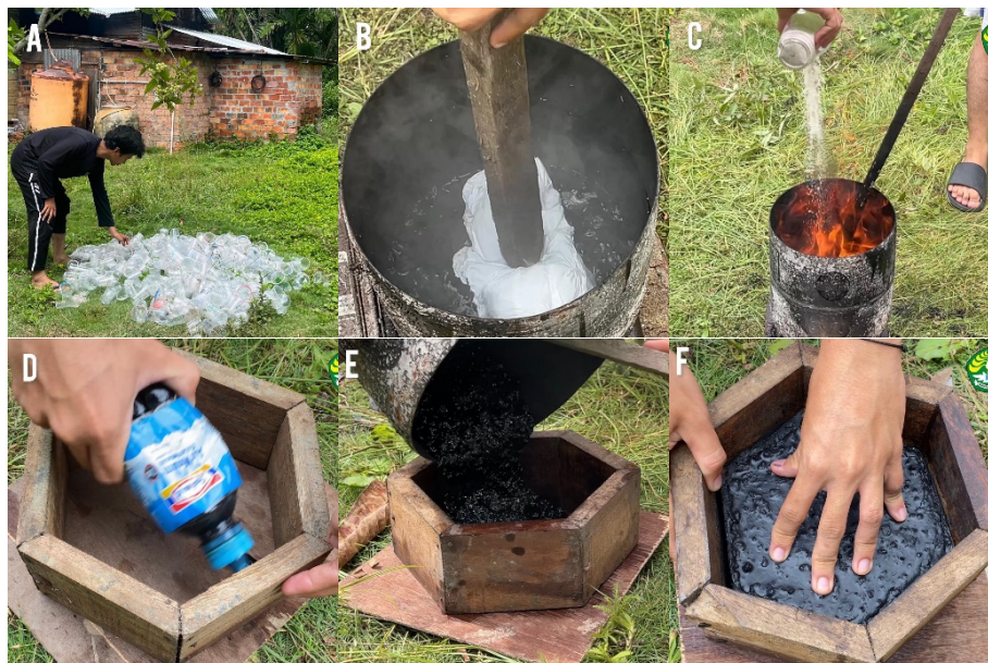
Gambar 3. (a) Pemilihan sampah plastik; (b) Pembakaran sampah plastik dan oli; (c) Penambahan pasir pada campuran; (d) Pengolesan oli pada cetakan; (e) Penuangan campuran; (f) Proses pendinginan
