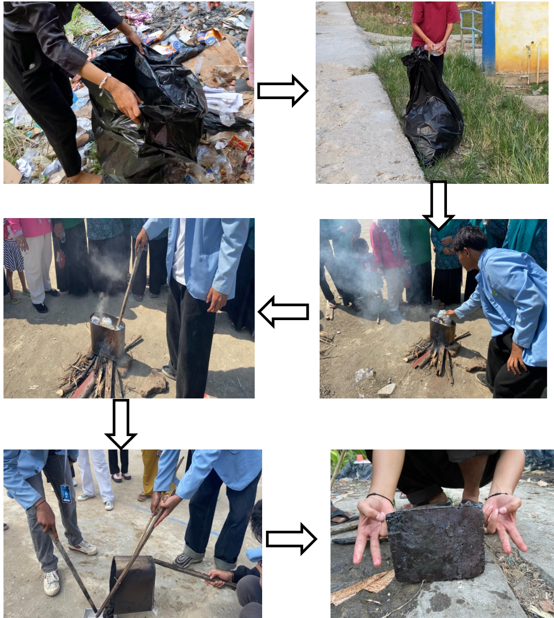
Gambar 3. Proses Pembuatan Paving Block
